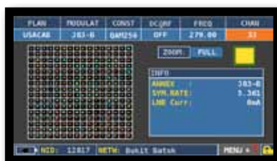
J83-B Konstellation, rechts werden die entsprechenden Modulationsparameter gezeigt
