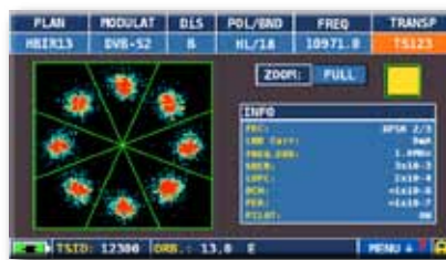
DVB-S2 Multistream Konstellation mit 8PSK Modulation, rechts die entsprechenden Modulationsparameter & ISSY
