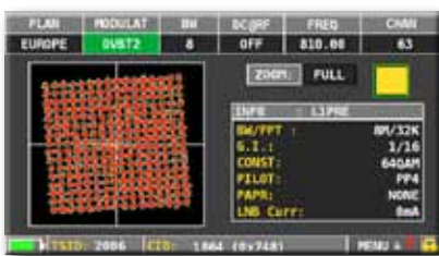
DVB-T2 in gedrehter Konstellation mit 256 QAM Modulation, rechts die entsprechenden Modulationsparameter & M-PLP
