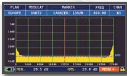
Invertierte MER vs TRÄGER MESSUNG
