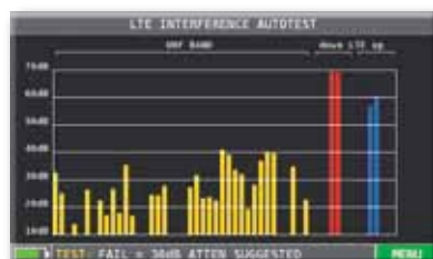
LTE Interferenz Autotest & TV BALKENDIAGRAMM
