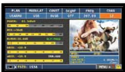
VSB Signal: alle Messungen, Bilddarstellung und Parameter auf einem Bildschirm
