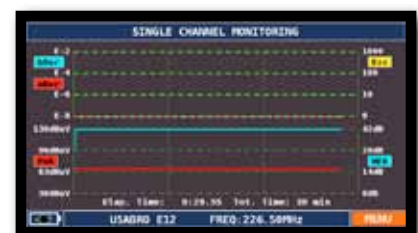
Langzeitüberwachung eines Kanals (z.B. über 30 Minuten)
