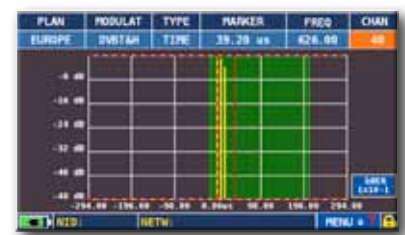
ECHO MESSUNG in SFN Netzwerken, mit Impulse Response in Echtzeit, der grüne Bereich zeigt den Guard Interval
