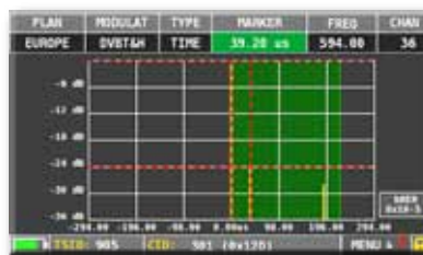
ECHO MESSUNG in SFN Netzwerken, mit Impulse Response in Echtzeit, der grüne Bereich zeigt den Guard Interval
